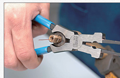
demontaža in montaža notranjega dela gorilnika
