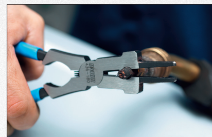
demontaža in montaža notranje šobe
