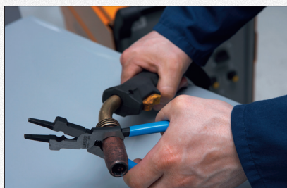
demontaža in montaža šobe
