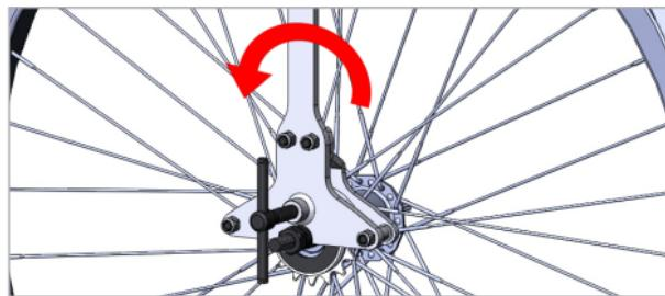
Z vrtenjem orodja v nasprotni smeri urinega kazalca, odvijemo verižnik. Za pravilno odvite je v pomoč tudi puščica na ročici, ki prikazuje pravilno smer odvita.
