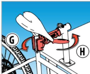
Adjust opened jaws (G) to seatpost or bike tube. Turn handle (H) until jaws firmly grabs the tube. • Nastavite odprto čeljust (G) sedežno oporo ali cev okvirja. Obrnite ročaj (H) dokler čeljusti ne zajamejo celotne cevi.
