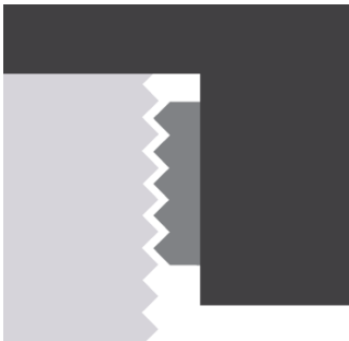
Mehrstufig einstellbare Gleitbacke
