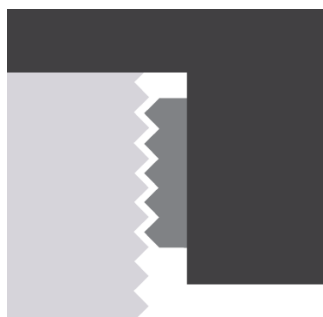
Podesiva klizna čeljust u nekoliko stupnjeva.
