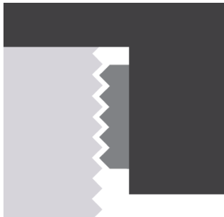
Mehrstufig einstellbare Gleitbacke
