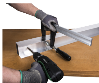
Rail en acier rectangulaire robuste, calibré et cranté. Finitions : mâchoire lacquée, rail zingué
