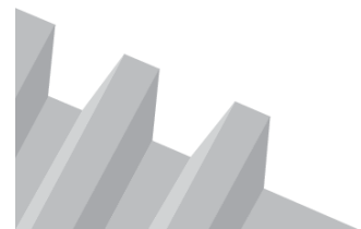
Schroef met trapeziumdraad: "Minder moeite-meer klemkracht".
