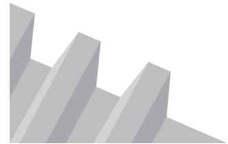
Schraube mit Trapezgewinde: Mehr Klemmkraft bei weniger Betätigungskraft.
