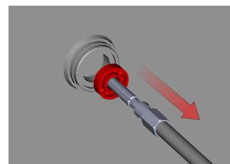
posle nekoliko udaraca, brzo i jednostavno se demontira ležaj iz kućišta bez oštećenja.
