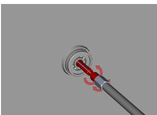
prvo postavite izvlakač kroz otvor ležaja koji treba demontirati sa kućišta. Zatim počnete da zavijate trn, koji ima funkciju da otvori telo izvlakača tako da se prilagodi veličini otvora ležaja.
