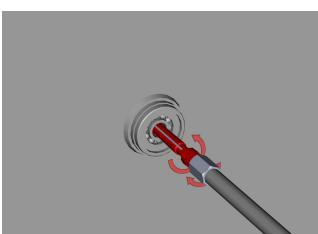
Prvo postavite izvlakač kroz otvor ležaja koji treba demontirati s kućišta. Zatim počnete zavijati trn, koji ima funkciju da otvori tijelo izvlakača tako da se prilagodi veličini otvora ležaja.
