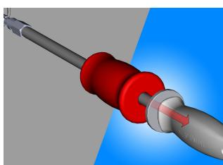
Pomoću čekića, jednakomjernim udarcima, počnete izbijati ležaj iz kućišta.
