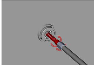
Schieben Sie den Abzieher durch die Bohrung des abzuziehenden Lagers. Schrauben Sie danach den Dorn fest, der den Körper des Abziehers öffnet, der sich an die Bohrung des Lagers anpasst.
