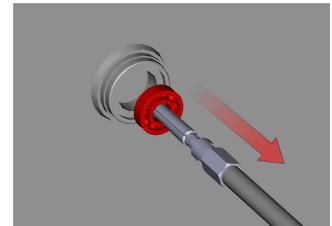
Plusieurs coups de marteau coulissant permettent le démontage rapide et facile du roulement, sans aucun dommage.
