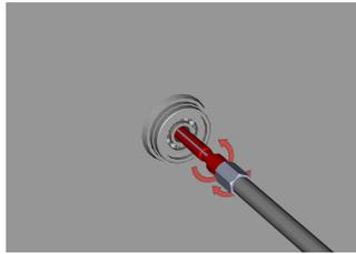
Prvo postavite izvlačač kroz otvor ležaja koji treba demontirati s kućišta. Zatim počnete zavijati trn, koji ima funkciju da otvori tijelo izvlačača tako da se prilagodi veličini otvora ležaja.
