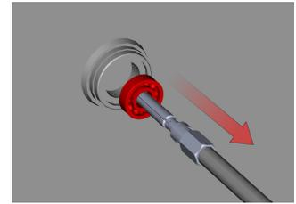
Poslije nekoliko udaraca, brzo i jednostavno se demontira ležaj iz kućišta bez oštećenja.
