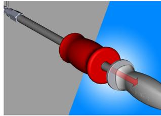
Pomoću čekića, jednakomjernih udarcima, počnete izbijati ležaj iz kućišta.
