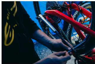
Nach dem Fixieren des Werkzeugs am Rahmen den unteren Auszug so ausziehen, dass dieser die Felge außen berührt.
