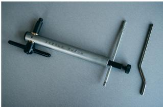
Hanger Genie hat ein zusätzliches Lineal, das insbesondere bei kleineren Rädern nützlich ist.
