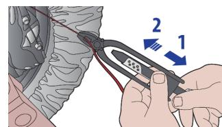
Pustite ručke klešta i uhvatite hromirani prsten. Povlačenjem prstena klešta će se okretati u pravcu kazaljke na satu i velikom brzinom uvrtati žicu.
