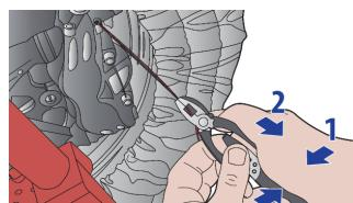
Pritiskom na ručke klešta i povlačenjem hromirane čaure između ručki zaključaćete klešta.
