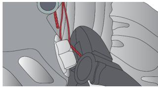
Drücken Sie die Zangengriffe zusammen, um den verchromten Verriegelungsschieber zu lösen, und verwenden Sie dann den integrierten Drahtschneider, um die Drähte auf Länge zu kürzen.
