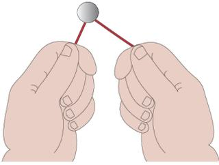
Führen Sie den Sicherheitsdraht in geeigneter Weise durch Ihr(e) Befestigungselement(e). Sie haben jetzt zwei Enden des Drahtes zum Verdrehen bereit.
