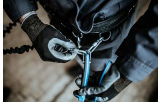
Карабинерът на ремъка трябва да бъде защитен срещу отваряне с помощта на заключващ пръстен.
