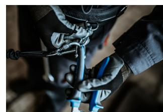
Otvorite karabinjer na pojusu i skinite alat sa karabinjera. Alat je sada spreman za upotrebu.
