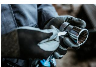
Pritisnите iglu u rupu s alatom za rastavljanje nasadnog ključa (stavka 1111), te istovremeno uklonite nasadni ključ sa račne i zamijenite nasadni ključ ili nastavak.
