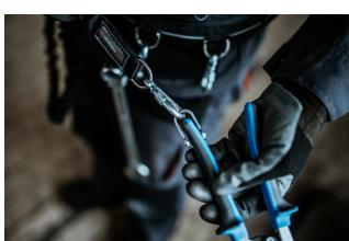
Na slici je prikazan pravilno pričvršćen alat na remenu za vezivanje s kojim koristimo alat.
