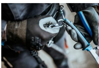
Pričvrstite karabiner na remenu za vezivanje na kopču alata. Kopče su dovoljno velike da drže 2 karabinera.
