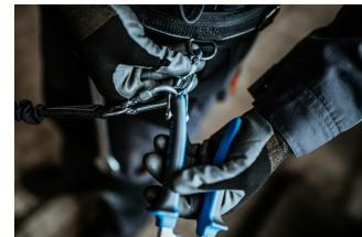
Otvorite karabinjer na pojusu i skinite alat sa karabinjera. Alat je sada spremam za upotrebu.
