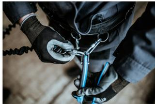
Der Karabiner am Umhängeband ist mit Schraubsicherung gegen Öffnen zu sichern.
