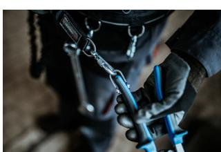
Coloque correctamente la herramienta en el cordón. Vuelva a colocar la herramienta en el cinturón siguiendo los pasos en orden inverso.
