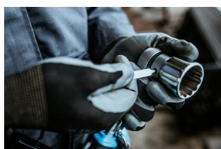
Используя ключ для смены торцевых головок (арт. 1111), вдавите штифт в отверстие, одновременно снимая головку с приводного квадрата трещотки, после чего установите другую головку или удлинитель.
