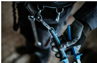
Slika prikazuje pravilno kačenje alata za vezni element. Okačite alat za pojас, idući koracima u obrnutom redosledu.
