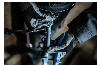
Откройте карабин на пояске и снимите с него инструмент с прикрепленной к нему стропой. Инструмент готов к использованию.
