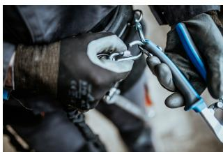
Карабинерът на ремъка е прикрепен към пръстена на инструмента.
