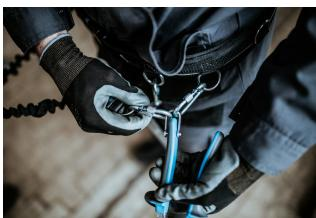
Карабинерът на ремъка трябва да бъде защитен срещу отваряне с помощта на заключващ пръстен.
