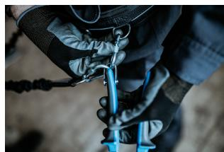
Vor Abnehmen des Werkzeugs vom Gürtel ist die Schraubsicherung am Karabiner am Gürtel zu öffnen.
