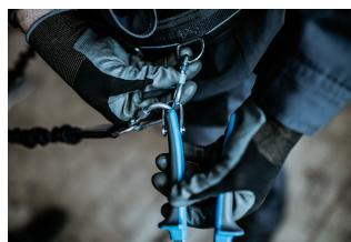
Antes de retirar la herramienta del cinturón, desenrosque el anillo de bloqueo del mosquetón del cinturón.
