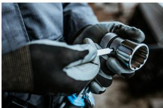
Mit dem Einsatzentferner (Art. 1111) den Stift in der Bohrung hineindrücken und gleichzeitig den Einsatz vom Antriebsvierkant der Ratsche abziehen. Danach Einsatz oder Aufsatz austauschen.
