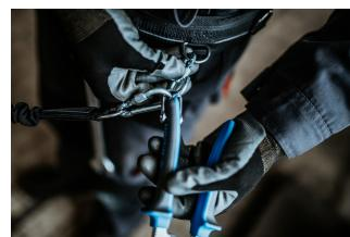
Den Karabiner am Gürtel öffnen und das am Umhängeband hängende Werkzeug vom Karabiner am Gürtel abnehmen. Das Werkzeug kann jetzt benutzt werden.
