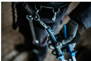
Slika prikazuje pravilno kačenje alata za vezni element. Okačite alat za pojaz, idući koracima u obrnutom redosledu.
