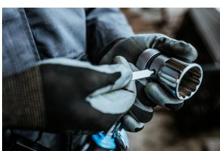
Используя ключ для смены торцевых головок (артикул 1111), вдавите штифт в отверстие, одновременно снимая головку с приводного квадрата трещотки, после чего установите другую головку или удлинитель.
