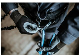
Карабинот на ременот треба да биде заштитен од отворање со помош на прстен за заклучување.
