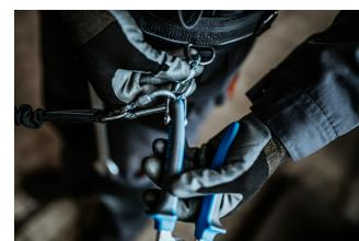
Otkopčajte karabiner na remenu i uklonite alat pričvršćen za užicu. Alat je sada spreman za rad.
