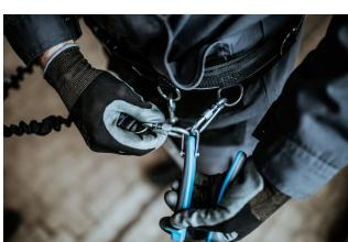
Karabina na lanku musí být chráněna proti otevření pomocí pojistného kroužku.
