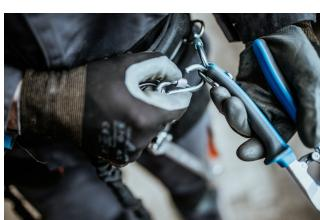
Karabina na lanku je připevněna ke kroužku na nářadí. Kroužky na nástrojích jsou dostatečně velké, aby pojaly 2 karabiny.
