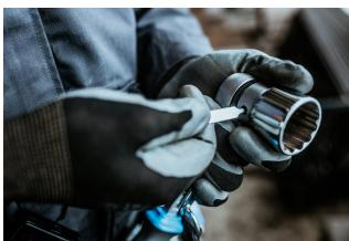
Pomocí odstraňovače nástrčných klíčů (článek 1111) zatlačte na kolík v otvoru, vyjměte nástavec ze čtyřhranu ráčny a poté ráčnu nebo nástavec přepněte.
