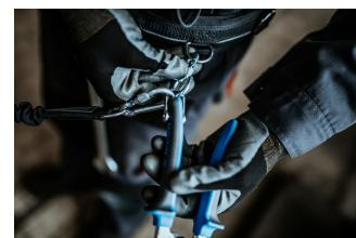
Otvorite karabinjer na pojusu i skinite alat sa karabinjera. Alat je sada spreman za upotrebu.
