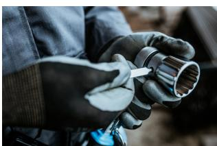
Koristeći se izbjajačem nasadnih ključeva (art. 1111) pritisnite pin u rupi i skinite ključ sa čegrtaljke, a zatim stavite drugi ključ ili produžetak.
