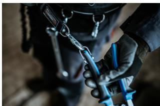
Igazitsuk meg a pányához csatlakoztatott szerszámot. Helyezzük vissza a szerszámot az övre a fenti lépések fordított sorrendjében.
