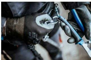
A pányván található karabinert a szerszámon található gyűrűhöz kell csatlakoztani. A gyűrűk mérete lehetővé teszi egyidejűleg 2 karabiner csatlakoztatását.
