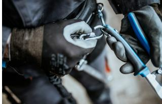
Карабинерът на ремъка е прикрепен към пръстена на инструмента.
