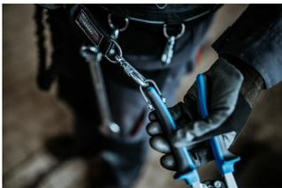
Richtiges Anhängen der Werkzeuge an Umhängebänder. Beim Zurückhängen des Werkzeugs an den Gürtel die gleichen Handlungen in umgekehrter Reihenfolge vornehmen.
