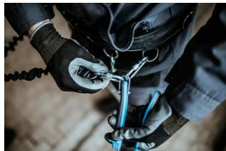
Карабинот на ременот треба да биде заштитен од отворање со помош на прстен за заклучување.
