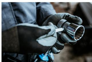
Usando lo strumento per la rimozione delle bussole (Articolo 1111), premere il perno nel foro mentre si rimuove la bussola dall'adattatore quadro del cricchetto e quindi sostituire la bussola o l'estensione.
