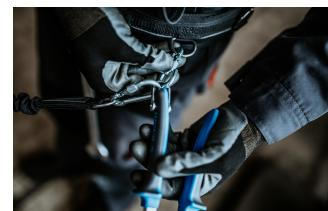
Otkopčajte karabiner na remenu i uklonite alat pričvršćen za uzicu. Alat je sada spreman za rad.
