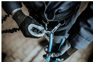
Karabina na lanku musí být chráněna proti otevření pomocí pojistného kroužku.
