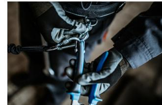
Otkopčajte karabiner na remenu i uklonite alat pričvršćen za užicu. Alat je sada spremан за rad.
