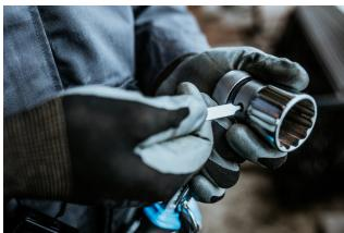
Koristeći se izbjicačem nasadnih ključeva (art. 1111) pritisnite pin u rupi i skinite ključ sa čegrtaljke, a zatim stavite drugi ključ ili produžetak.
