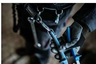
Slika prikazuje pravilno kačenje alata za vezni element. Okačite alat za pojus, idući koracima u obrtnutom redosledu.
