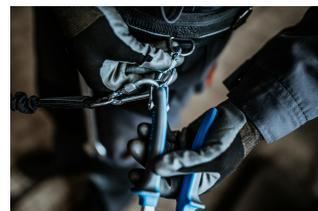
Ouvrir le mousqueton de la ceinture et sortir l'outil, attaché à la lanière, du mousqueton de la ceinture. L'outil est maintenant prêt à l'usage.
