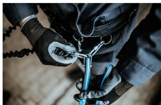
Le mousqueton sur la lanière doit être sécurisé contre toute ouverture accidentelle grâce à l'écrou de sécurité
