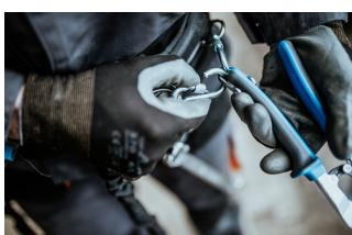
Karabina na lanku je připevněna ke kroužku na náradí. Kroužky na nástrojích jsou dostatečně velké, aby pojaly 2 karabiny.
