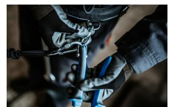
Otvorite karabinjer na pojusu i skinite alat sa karabinjera. Alat je sada spremjan za upotrebu.
