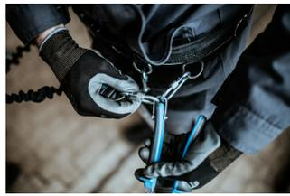
El mosquetón del elemento de amarre debe estar protegido contra la apertura mediante un anillo de seguridad.
